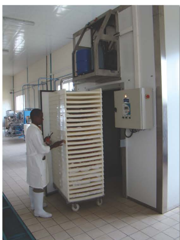
Séchage par déshumidification
