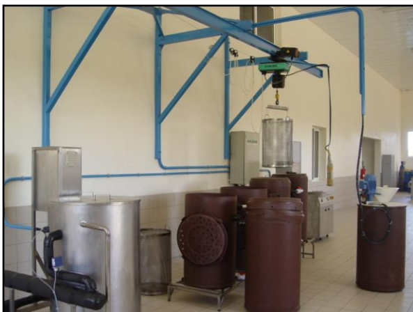
Photo 3 : Ligne de déshydratation osmotique
